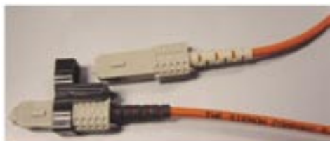
Connecteur SC Duplex avec clip de maintien de polarité
